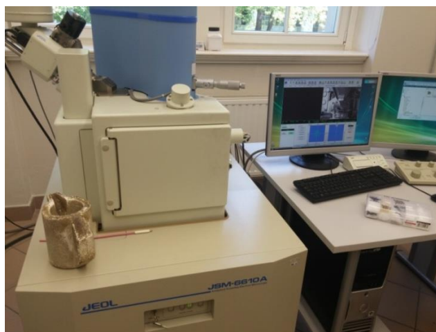
Ryc. 7. Skaningowy mikroskop elektronowy z funkcją analizy składu chemicznego - JEOL JSM- 6010A Analytical Scanning Electron Microscope (laboratorium Katedry Inżynierii Pojazdów, Politechnika Wrocławska)
