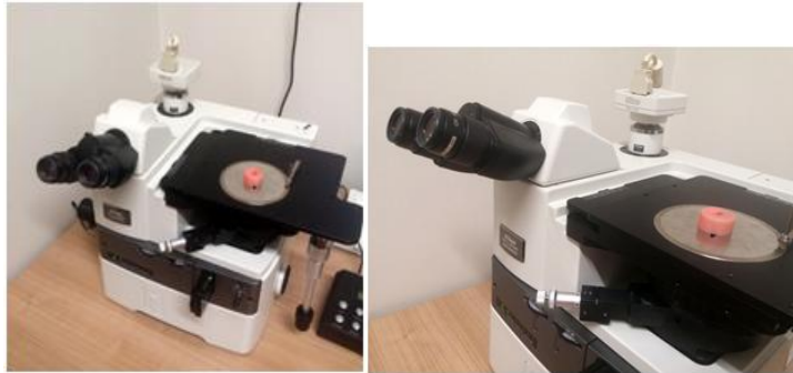
Ryc. 8 Mikroskop świetlny MA200 firmy Nikon (laboratorium Katedry Inżynierii Pojazdów, Politechnika Wrocławska)
