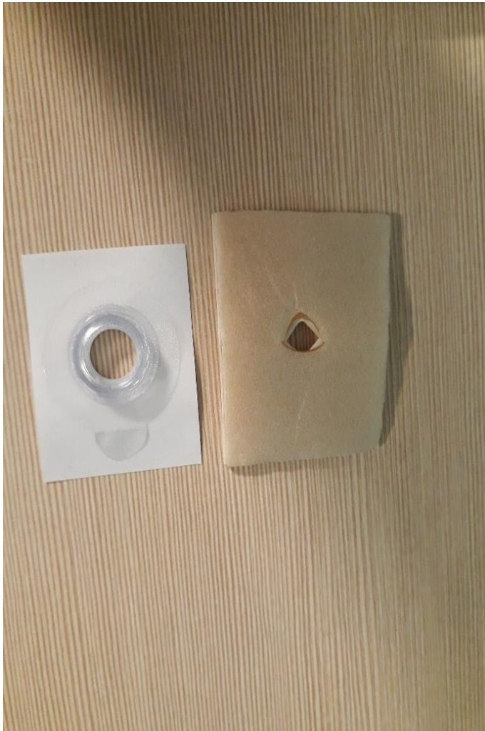
Fotografia 3. Po lewej: samoprzylepny pierścień mocujący czujnik do pomiaru T_{cp0_2} . Po prawej: pasek POH stosowany jako dodatkowe uszczelnienie.
