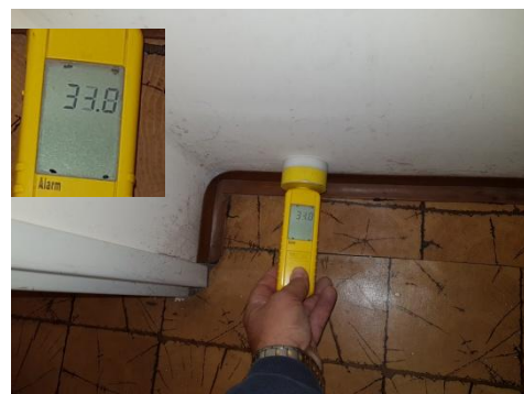
Skala pomiarowa dla miernika mikrofalowego i dielektrycznego T 650, T-600
