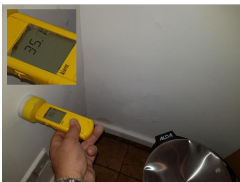
Skala pomiarowa dla miernika mikrofalowego i dielektrycznego T 650, T-600
