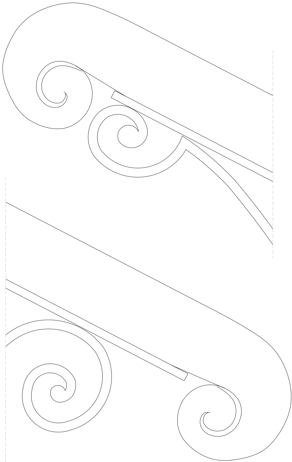
DETALE ZAKOŃCZENIA PORĘCZY skala 1:2
