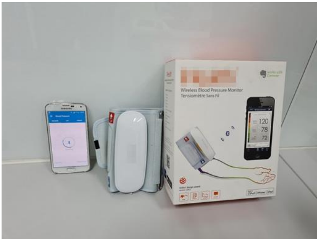
Rycina 3. Zestaw do przeprowadzania pomiaru CT za pomocą rozwiązań telemedycznych (urządzenie iHealth oraz smartfon) Źródło: Opracowanie własne
