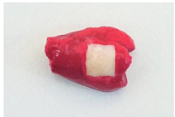
Ryc. 1 Przygotowane próbki pokryte lakierem kwasoodpornym z odstoniętym szkliwem w postaci okienka o wymiarach 4 mm/4 mm Źródło: Opracowanie własne.
