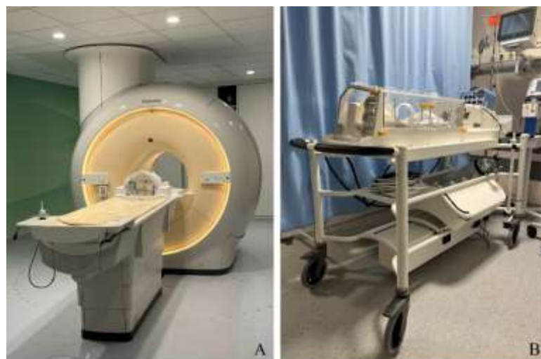
Ryc. 36. Aparat MR używany do wykonywania badań mózgu noworodków (A) oraz inkubator do badań MR w polu 3T (B)
