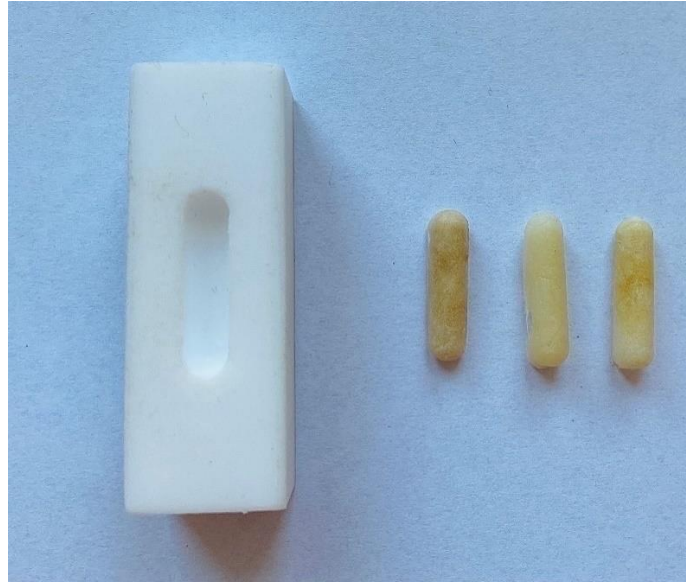
Fot.6. Formy teflonowe – projektu prof. Rafał J. Wigłusz do wytwarzania kompozytów oraz otrzymane próbki.
