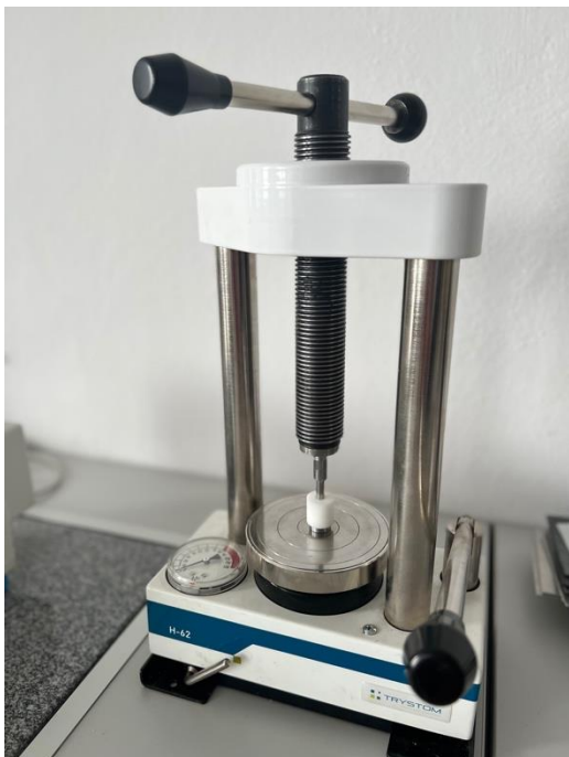
Fot. 1. Ręczna prasa służąca do wytwarzania tabletek z otrzymanych kompozytów.
