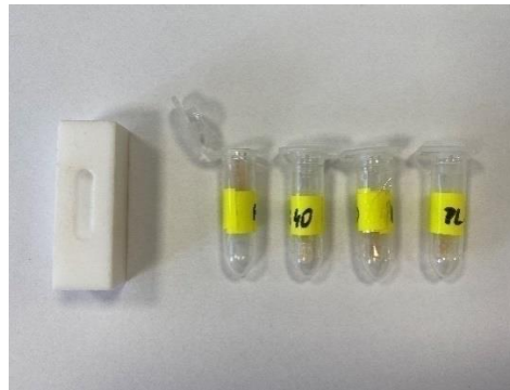
Fot.8 Teflonowa forma służąca do wytwarzania monolitów kompozytowych.
